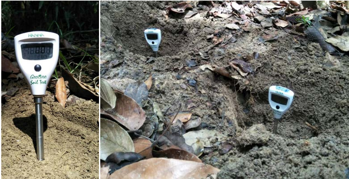
ภาพที่ ๑๐ อุปกรณ์และวิธีวัดค่าการนำไฟฟ้าในโป่งเทียม ภาพซ้าย เป็นการวัดที่ระดับความลึก ๑๕ เซนติเมตร และ ภาพขวา เป็นการวัดที่ระดับความลึก ๓๐ เซนติเมตร
